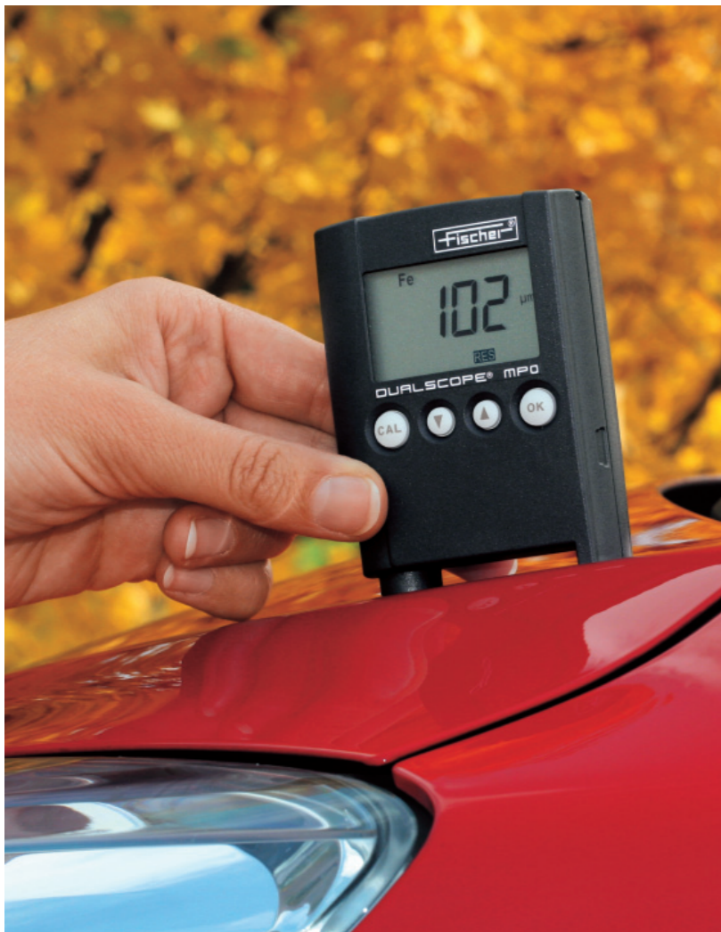
使用DUALSCOPE® MP0检测油漆厚度，例如：汽车车身
