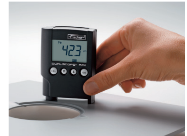
测量铁上油漆的厚度
