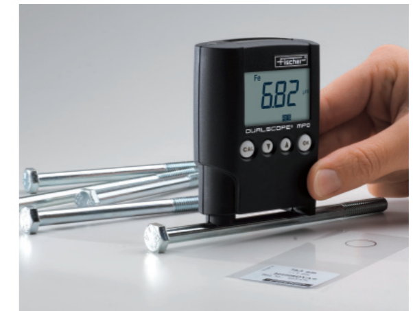
测量铁上镀锌层的厚度，测量小曲率工件必须进行校准以获得准确的测量结果
