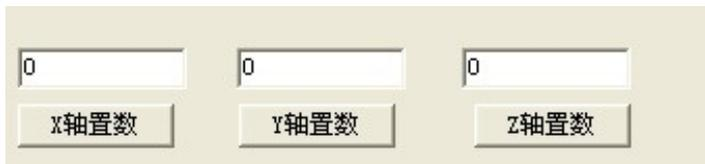
单独对某轴设置读数值，设置后的读数会读到新的设置数。设置编码器值函数请参考表 4-1 的函数 4。
